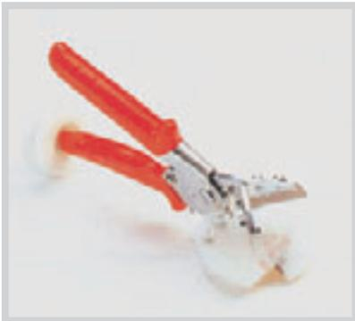
Q-LON-Zange mit Einzugsrolle für 90° und Endschnitt für Montage im Flügel.
