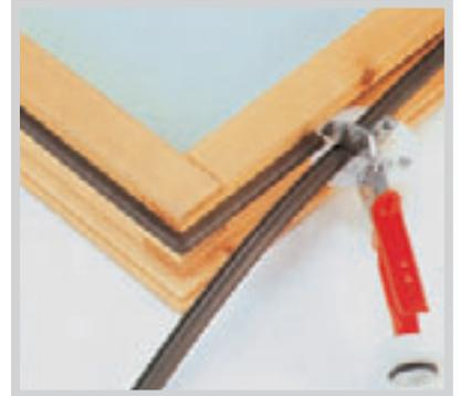
3. Der Endschnitt: Durch das Anlegen des schrägen Anschlages der Zange an das Profilende, wird die Dichtung auf die exakte Länge geschnitten.
