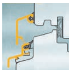
Universalschiene SPREE D ohne Flügelfalz Entwässerung über Regenschutzschiene falzmaßunabhängig
